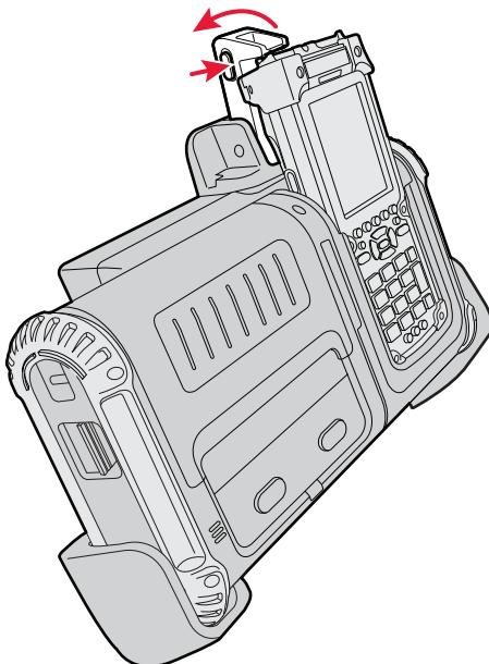
**2** Потяните рычажок собачки, вытяните PW50 вперед и снимите его с автомобильной стойки.
