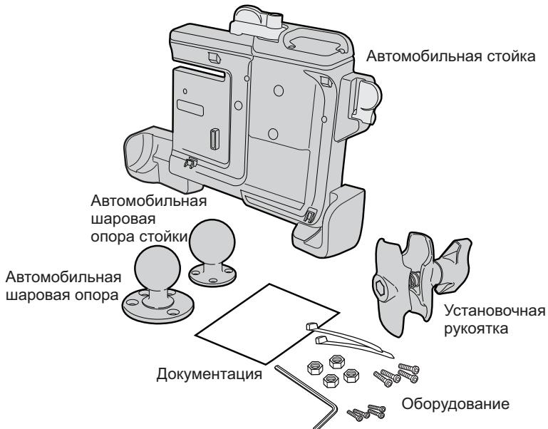
*Содержимое упаковочной коробки автомобильной стойки PW50*
