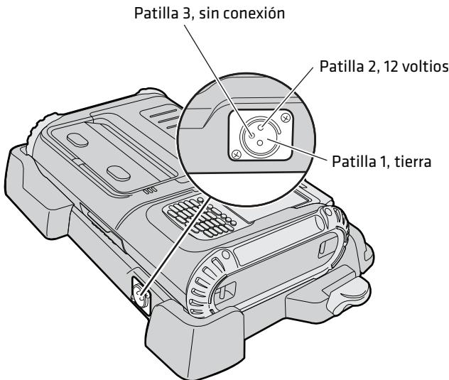
*Esta ilustración describe las asignaciones de patillas para el conector de alimentación del montaje para vehículos.*
