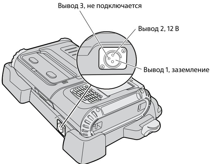
На этой иллюстрации показана разводка контактов разъема питания автомобильной стойки.
