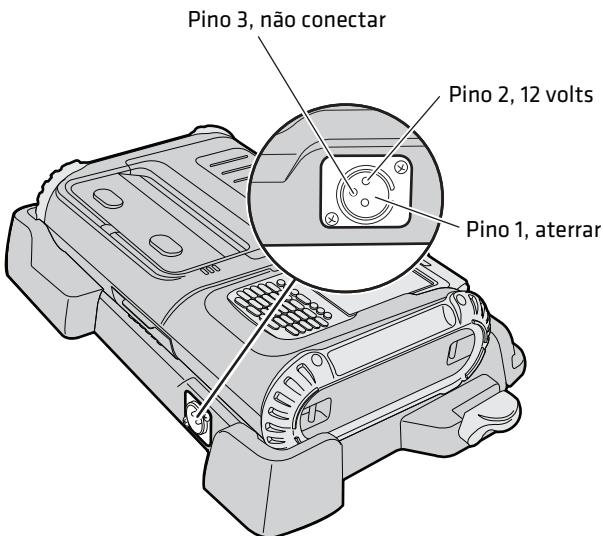
*Essa ilustração descreve as pinagens para o conector de alimentação do suporte do veículo.*
