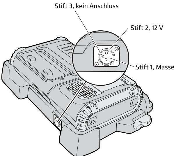
Diese Abbildung zeigt die Stiftbelegung für den Fahrzeubefestigungsanschluss.
